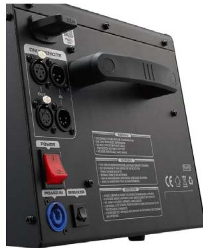
**Réglage de l'adresse** - Utilisez la fonction DMX-512 Address dans le menu afin d'attribuer les adresses DMX. La machine peut être réglé par deux canaux DMX. L'adresse de départ est déterminée sur le 1er canau détecté par le contrôleur. Assurez-vous que les canaux de se superposent pas afin que la machine fonctionne correctement.
